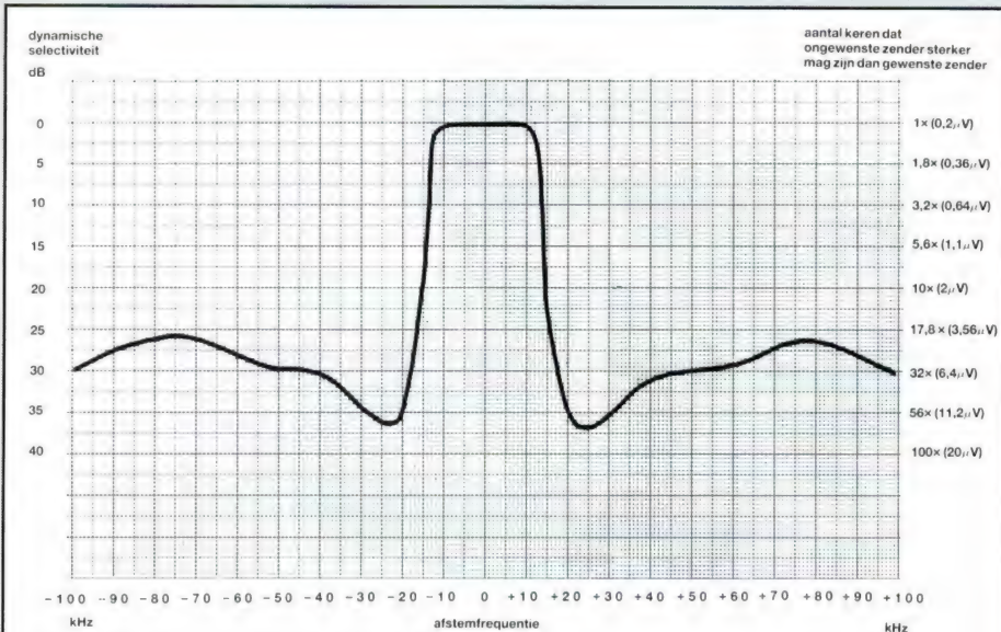
FIG. 7. Dynamische selectiviteit ICOM R1 op VHF-UHF in FM-n. De curve geeft aan hoe sterk een niet beluisterde zender op een bepaalde frequentie afstand mag zijn, voordat de signaal-ruisverhouding van de gewenste zender van 20 dB S+N terugloopt tot 14 dB S+N .
